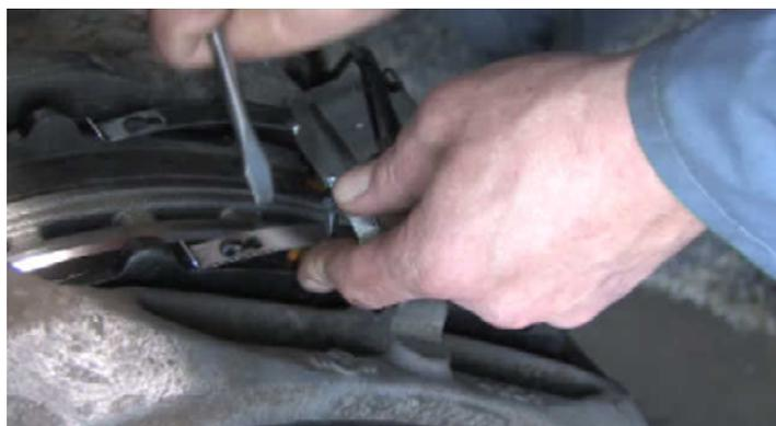
Instale o suporte de fixação da pastilha com o conjunto do sensor de desgaste, parafuso e pino de segurança. Instale a chapa de proteção.
