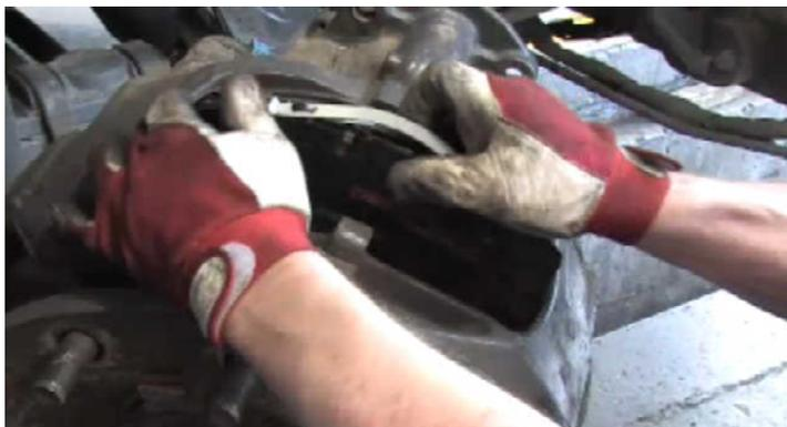
Insira a pastilha de travão interior. Puxe a pinça de travão para o exterior do veículo e insira a pastilha de travão exterior.
