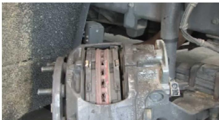
Retire a pastilha de travão interior. Puxe a pinça de travão para o exterior do veículo e retire a pastilha de travão exterior.
