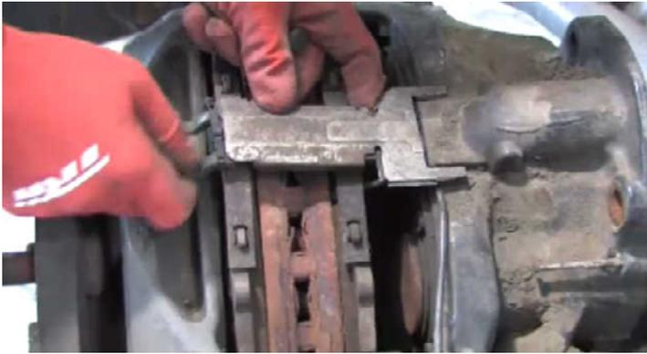
Retire o pino de segurança, anilha e parafuso no suporte de fixação da pastilha. Retire as pastilhas de travão, incluindo o suporte de fixação e o conjunto do sensor de desgaste.
