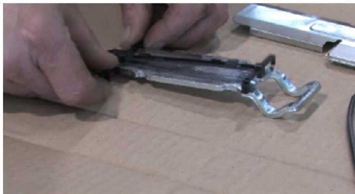
Instale a guia do cabo e o conjunto do sensor de desgaste no suporte de fixação da pastilha.
