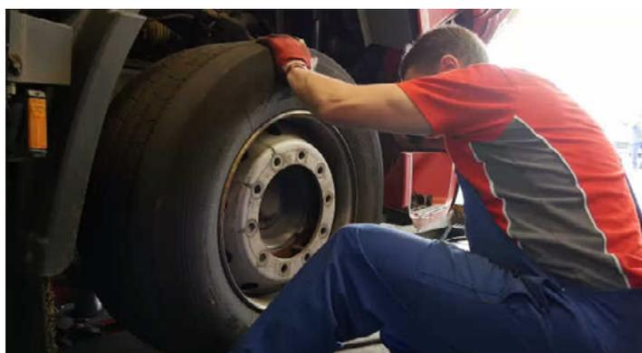
Monte a roda, centre-a e fixe-a com o binário de aperto especificado pelo fabricante do veículo.
