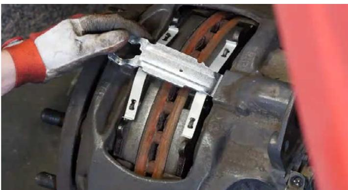
Instale o suporte de fixação da pastilha, parafuso, anilha e pino de segurança.
