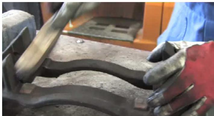
Remova qualquer sujidade e vestígios de corrosão da superfície de contacto das pastilhas de travão, no suporte de travão. Limpe o suporte cuidadosamente com o líquido de limpeza de travões TRW.
