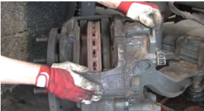
Verifique o funcionamento correto dos pinos guia, movendo o corpo da pinça para a frente e para trás. Deve ser possível mover o corpo da pinça manualmente (sem ferramentas) ao longo de toda a área de deslocamento.
