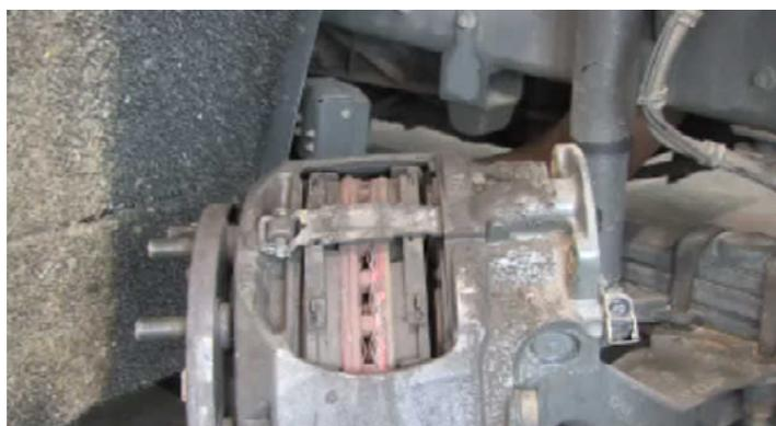
Retire o pino de segurança, anilha, parafuso e suporte de fixação da pastilha.
