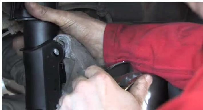
清洁转向节在减震架的接触面，把减震架放入其安装位置。然后安装固定螺丝。给螺纹涂上螺纹锁固剂并使用汽车制造商规定的扭矩拧紧螺母。
