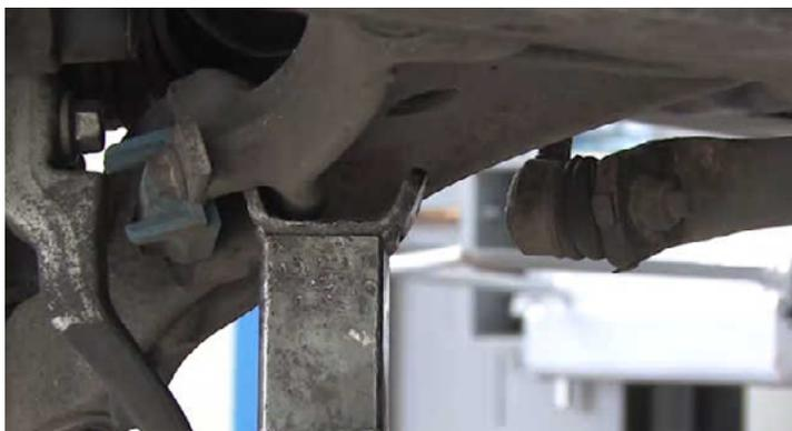
用一个合适的工具（如变速箱千斤顶）支撑在底部控制臂的转向节。然后松开并取下在转向节减震架的固定螺栓。
