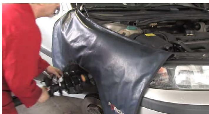
把减震架放入其安装位置。为了临时固定将螺母拧紧在减震架支座的螺杆上。
