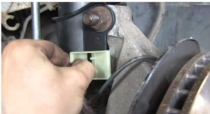
安装提供的ABS传感器电缆支架，并将其固定在减震架和车身的支架中。
