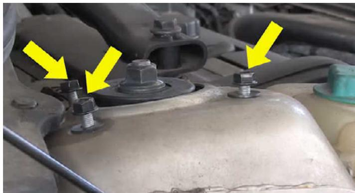
使用汽车制造商规定的扭矩拧紧减震架支座的螺母。
