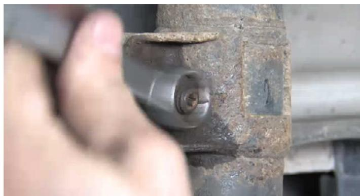
拧松固定防倾杆的螺丝，并从减震架的支架上拆下球头。
