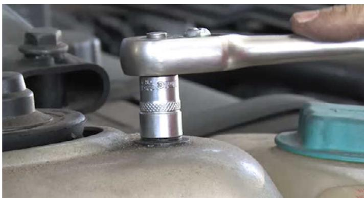
松开并拆下在减震架支座的三个螺杆螺母。现在可以将减震架完全从车辆中取出。
