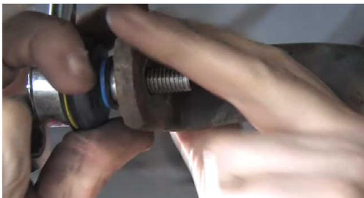
安装防倾杆并使用汽车制造商规定的扭矩拧紧螺母。
