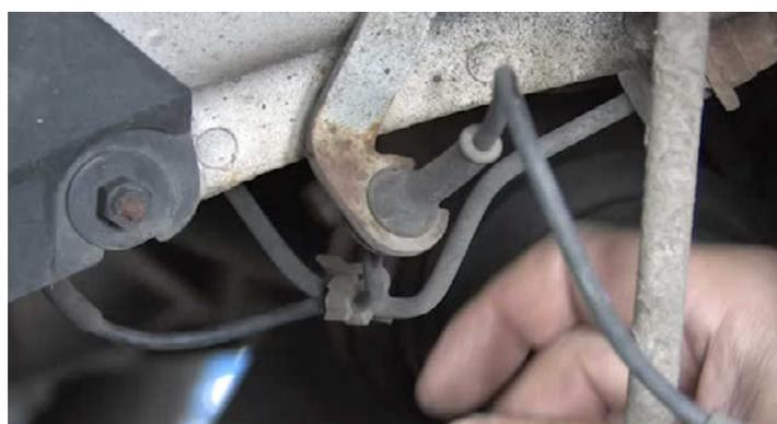
首先将ABS传感器电缆从车身和减震架的支架松开，然后给要拧松的螺栓喷上渗透油。
