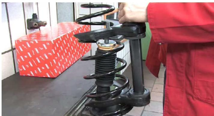
使用合适的弹簧压缩器按压弹簧，直到活塞杆螺纹超出弹簧的上端。
