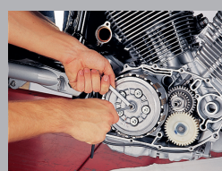
6. Ajustar el juego del embrague al mecanismo de desembrague, diferente en función del vehículo.
