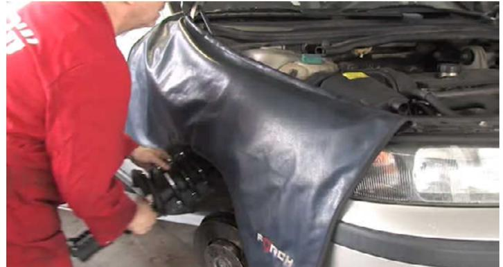
Coloque el amortiguador McPherson en su posición de montaje. Para fijarlo provisionalmente, inserte la tuerca en el espárrago cojinete de apoyo del amortiguador.
