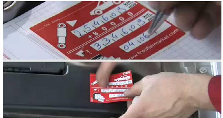
Anote en la etiqueta adhesiva de TRW XZB487(A) el kilometraje actual y 80.000 como el kilometraje para realizar la próxima revisión. A continuación, anote la fecha de reparación y pegue la etiqueta en un lugar visible del compartimiento del motor.
