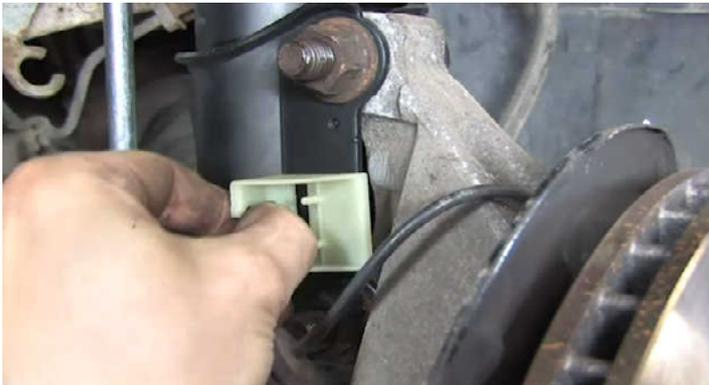
Monte el soporte suministrado para el cable del sensor ABS y fije el cable a los soportes en el amortiguador McPherson y en la carrocería.
