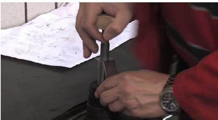
Retire el bloqueo del vástago de pistón y empuje este varias veces hacia dentro de la carcasa del amortiguador, tal como se muestra en el vídeo.
