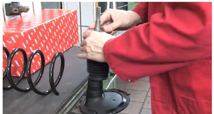
Monte el tope del amortiguador ya ensamblado y los muelles de suspensión.
