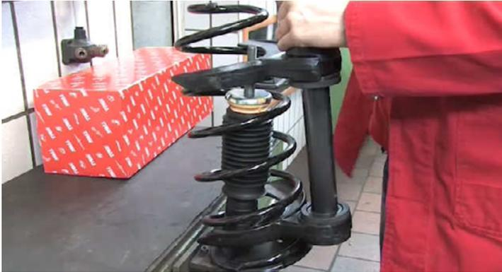
Presione los muelles con un tensor adecuado hasta que la rosca del vástago del pistón sobresalga por el extremo superior del muelle.
