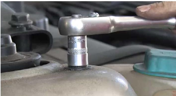
Afloje y retire las tuercas de los tres espárragos en el cojinete de apoyo del amortiguador. El amortiguador McPherson puede retirarse ahora por completo del vehículo.
