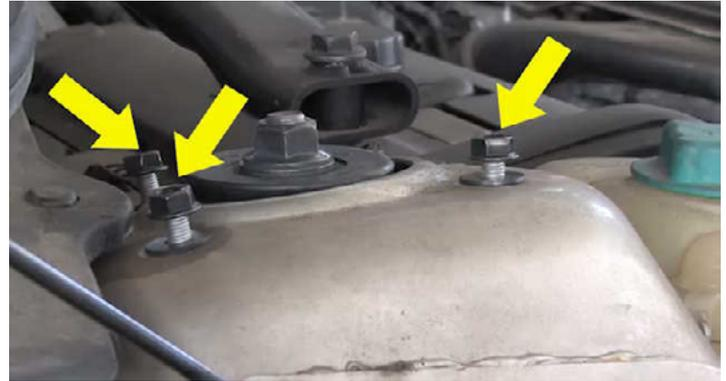
Apriete las tuercas del cojinete de apoyo del amortiguador al par especificado por el fabricante del vehículo.
