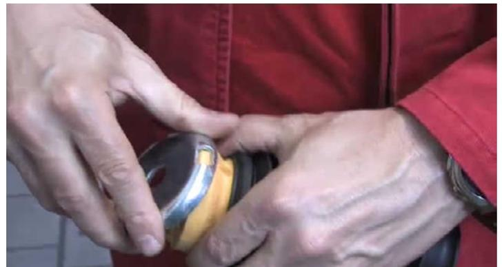
Una el manguito guardapolvo con el tope del amortiguador y la placa metálica.
