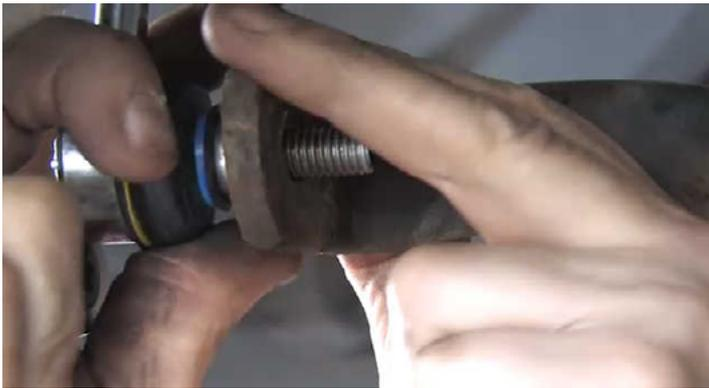
Monte la barra estabilizadora y apriete las tuercas al par especificado por el fabricante del vehículo.
