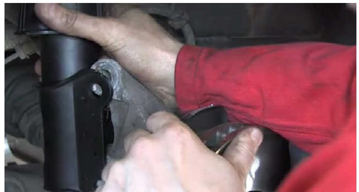
Limpie las superficies de contacto de la mangueta con el amortiguador McPherson y coloque el amortiguador en su posición de montaje. A continuación, monte los tornillos de fijación. Aplique compuesto fijador de tornillos en la rosca y apriete las tuercas al par especificado por el fabricante del vehículo.
