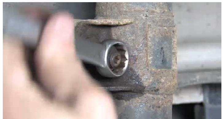
Afloje los tornillos que fijan la barra estabilizadora y retire la cabeza esférica del soporte en el amortiguador.
