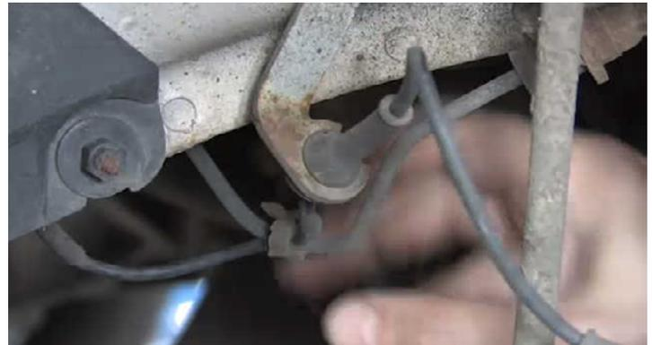
Primero afloje el cable del sensor ABS del soporte en la carrocería y en el amortiguador McPherson y rocíe los tornillos aflojados con aceite penetrante.
