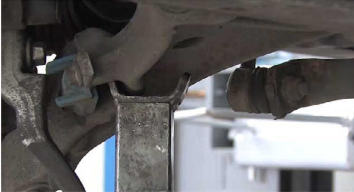
Apoye la mangueta en el brazo de suspensión inferior con ayuda de una herramienta adecuada (p. ej. un elevador de cajas de cambios). Afloje y retire los tornillos de retención que sujetan el amortiguador McPherson a la mangueta.
