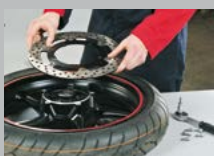
4. Démontez le vieux disque de frein et nettoyez la surface de pose.
