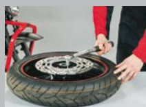
5. Installez le nouveau disque de frein et serrez les vis de fixation.
