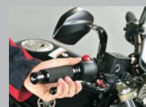
6. Contrôlez le point de poussée du frein et la mobilité de la roue. Nettoyez le disque de frein.
