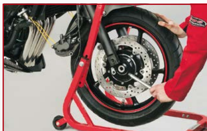
1. Placer la moto sur béquille et démonter l'étrier de frein.
