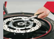
3. Desserrer les vis de fixation du disque de frein.
