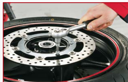
3. Desserrer les vis de fixation du disque de frein.
