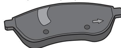
Plaquette de frein avec indication du sens de montage et échancrure sur la plaque arrière de la plaquette
