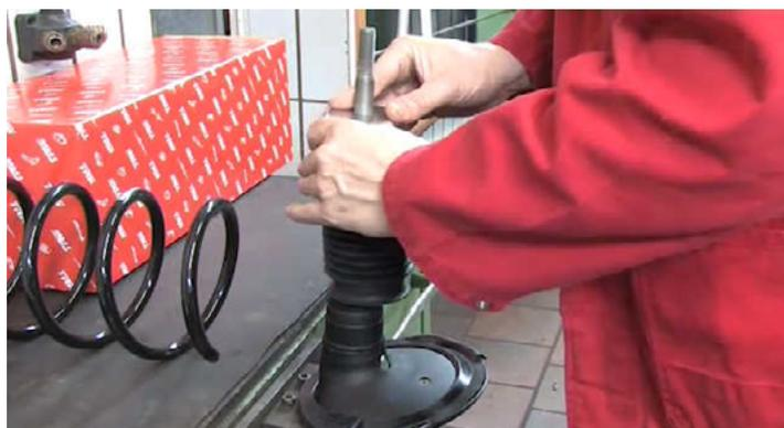
Montare il tampone di fine corsa assemblato e la molla.
