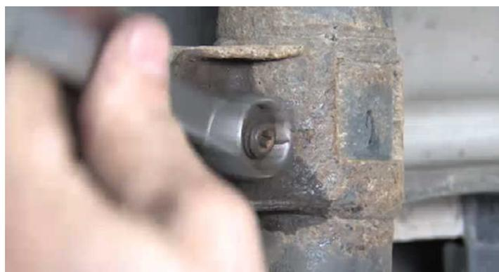
Svitare le viti di fissaggio della barra stabilizzatrice e rimuovere la testa dello snodo sferico dal supporto dell'ammortizzatore.
