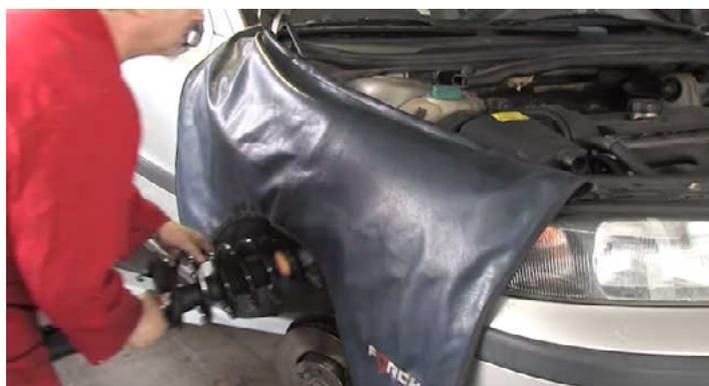
Portare l'ammortizzatore in posizione di montaggio. Per un fissaggio provvisorio applicare i dadi di fissaggio superiori dell'ammortizzatore.
