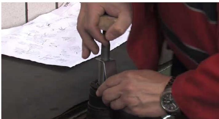
Rimuovere l'arresto dello stelo del pistone e spingere un paio di volte lo stelo, come illustrato nel video, nell'alloggiamento dell'ammortizzatore.
