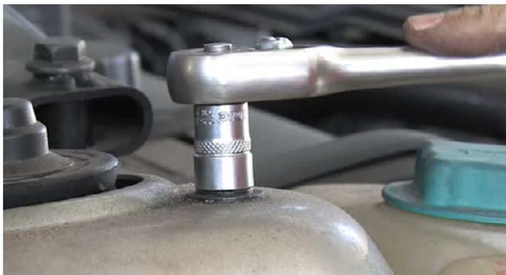
Svitare e rimuovere i dadi di fissaggio della parte superiore dell'ammortizzatore. A questo punto l'ammortizzatore può essere estratto completamente dal veicolo.
