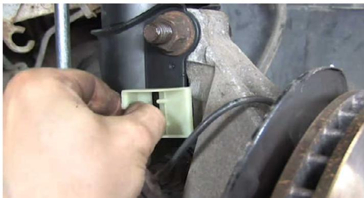
Montare il supporto per il cavo del sensore ABS fornito in dotazione e fissarlo ai supporti dell'ammortizzatore.
