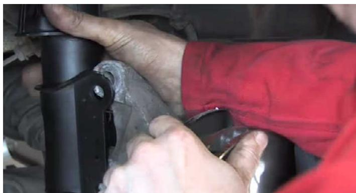
Pulire le superfici d'appoggio del fuso a snodo sull'ammortizzatore e portare l'ammortizzatore in posizione di montaggio. Quindi montare le viti di fissaggio. Trattare le filettature con frenafili e serrare i dadi con la coppia di serraggio prescritta dalla casa costruttrice.
