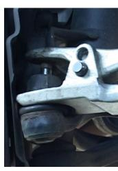
Demontieren Sie beide Spurstangenköpfe von den Achsschenkeln (Spurstangenhebel).
