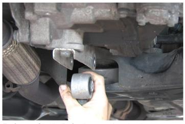
Entfernen Sie die Befestigungsschraube der Drehmomentstütze an der Halterung am Motorblock und ziehen sie die Drehmomentstütze nach unten.
