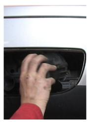
Um Zugang zu den Steckverbindungen der Pumpe zu erhalten, empfiehlt es sich, die Nebelleuchte auszubauen. Entfernen Sie dazu zunächst die Abdeckung und anschließend die komplette Leuchte.
