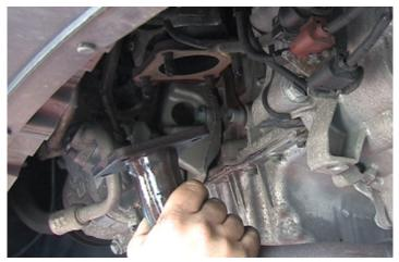
Entfernen Sie im nächsten Schritt die Befestigungsschrauben des vorderen Auspuffrohres vom Auspuffkrümmer. Ziehen Sie das Auspuffrohr ab.
