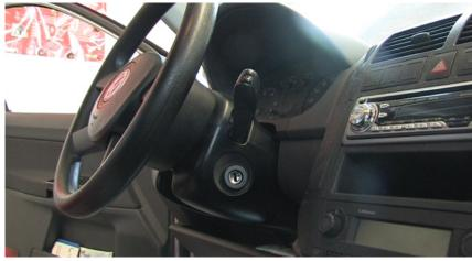
Vor Beginn der Arbeiten, muss die Batterie abgeklemmt, und das Lenkrad, in Mittelstellung, mit dem Lenkradschloss fixiert werden. Dies verhindert ein Verdrehen, und damit eine Beschädigung der Kontaktwalze des Airbags.
