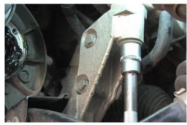
Entfernen Sie die Schrauben der beiden Achsträger. Jetzt können Sie die Motortraverse mit den Querlenkern und dem Lenkgetriebe vorsichtig ablassen.
