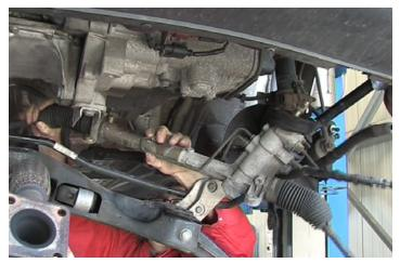
Für den nächsten Arbeitsschritt wird ein zweiter Mechaniker benötigt. Entfernen Sie die komplette Einheit aus Lenkgetriebe, Schläuchen und Motorpumpenaggregat aus dem Fahrzeug.
