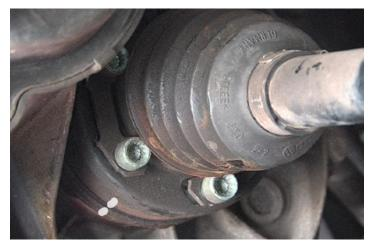
Demontieren Sie die Befestigungsschrauben der linken Antriebswelle am Getriebe.
