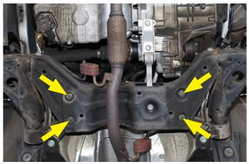
Lösen und entfernen Sie die Schrauben, mit denen das Lenkgetriebe an der Motortraverse befestigt ist.
