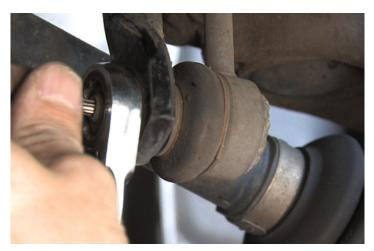
Lösen Sie beide Stabilisatorstreben vom Stabilisator.
