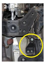
Nachdem Sie, mit einem Hydraulikheber, die Motortraverse abgestützt haben (1), können Sie rechtes und linkes Halteblech (2) entfernen.
