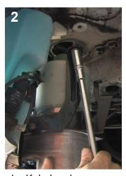
Lösen Sie die Befestigungen der Kabel und Leitungen an der Karosserie(1). Demontieren Sie die Hydraulikpumpe, indem Sie die Schrauben des Haltebügels entfernen (2).
