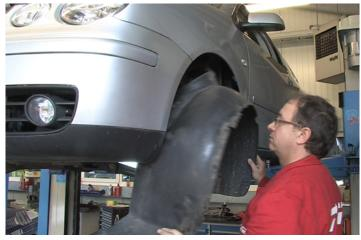
Entfernen Sie die Radhausverkleidung und alle Verkleidungen, die den Zugang zur Lenkungspumpe und ihrer Verkabelung erschweren könnten.
