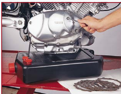
1. Przygotuj narzędzia - zabezpiecz podłogę - spuścić olej
