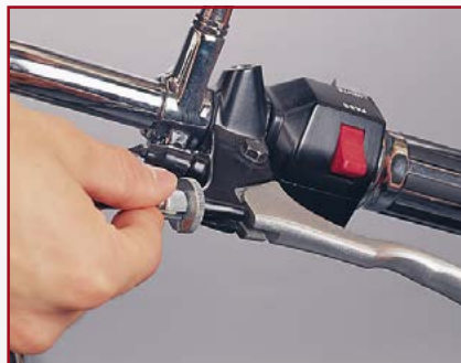
8. Wyreguluj luz linki sprzęgła
