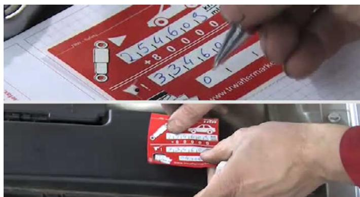
Anotar no autocolante TRW XZB487(A) os quilómetros do veículo e adicionar 80.000 para a próxima inspeção dos amortecedores. Anotar seguidamente a data da reparação e posicionar o autocolante numa posição bem visível no compartimento do motor.
