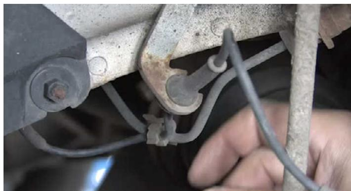
Desencaixar primeiro o cabo do sensor ABS do suporte na carroçaria e no amortecedor e aplicar um pouco de lubrificante nos parafusos que pretende desapertar.
