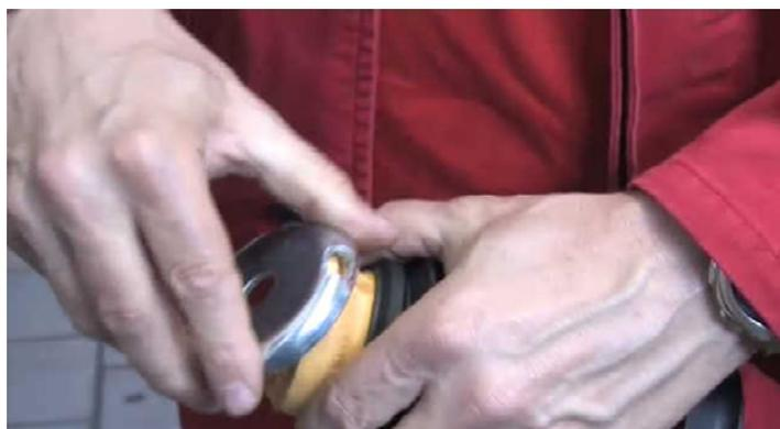
Unir o fole de proteção com batente e a tampa metálica.
