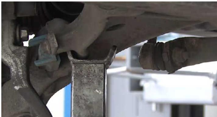
Apoiar a manga de eixo, no braço transversal inferior, com uma ferramenta adequada (p. ex. macaco de transmissão). Desapertar e retirar seguidamente os parafusos de fixação do amortecedor na manga de eixo.
