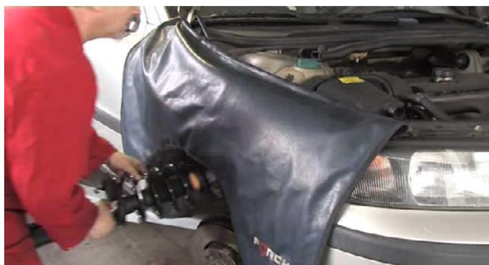
Posicionar o amortecedor na sua posição de montagem. Para permitir uma fixação provisória, deve-se enroscar as porcas nos pinos roscados do suporte de apoio do amortecedor.
