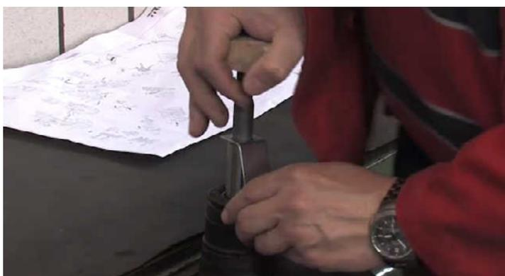
Remover o bloqueio da haste e pressionar algumas vezes para dentro do corpo do amortecedor (conforme exibido no vídeo).
