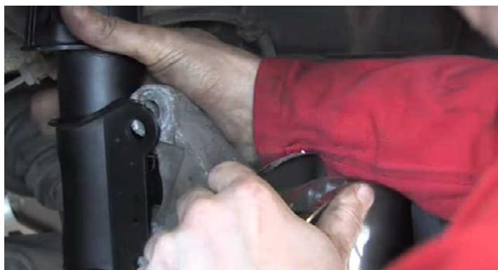
Limpar as superfícies de encosto da manga de eixo no amortecedor e ajustar o amortecedor na sua posição de montagem. Montar seguidamente os parafusos de fixação. Aplicar um pouco de fixador nas roscas e apertar as porcas com o binário predefinido pelo fabricante automóvel.
