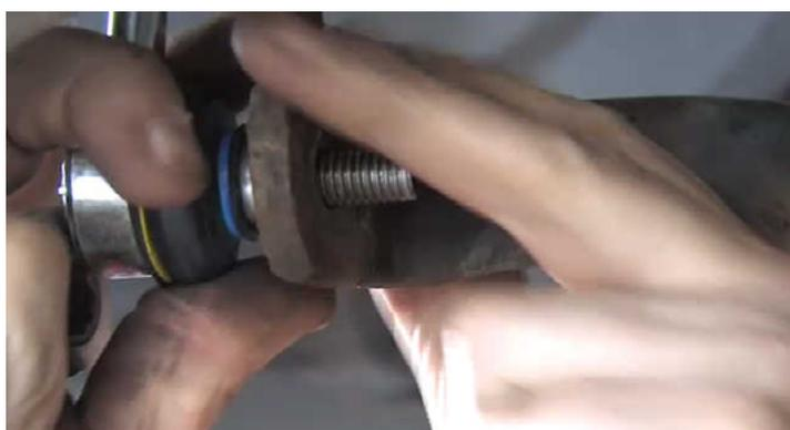
Montar a barra estabilizadora e apertar as porcas com o binário predefinido pelo fabricante automóvel.
