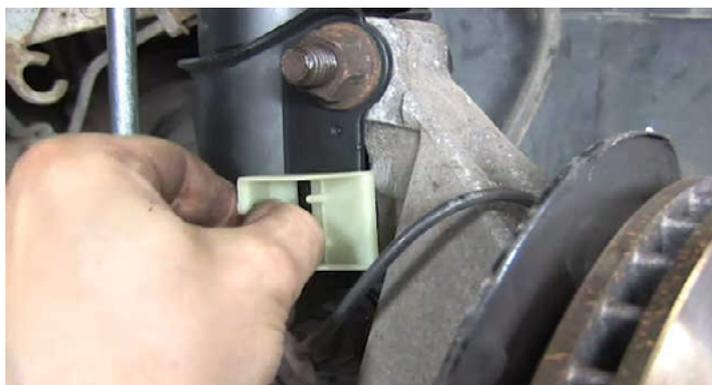
Montar o suporte fornecido para o cabo do sensor ABS e fixá-lo aos suportes do amortecedor e da carroçaria.
