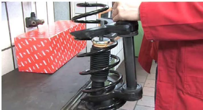
Comprimir a mola helicoidal, utilizando para isso a ferramenta adequada, até a rosca da haste ficar acima da extremidade superior da mola.
