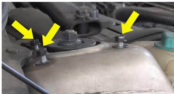
Apertar as porcas do suporte de apoio do amortecedor com o binário predefinido pelo fabricante automóvel.
